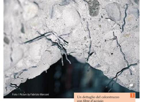
all'interno della massa di calcestruzzo realizza una microarmatura tridimensionale diffusa in un modo omogeneo ed in grado così di contrastare le tensioni da ritiro plastico, tanto più elevato quanto più l'aria è secca e circola velocemente. Altri fattori che influenzano questo tipo di ritiro sono, naturalmente, il dosaggio di cemento, il rapporto A/C (acqua/cemento), la temperatura dell'aria e l'esposizione al sole.
