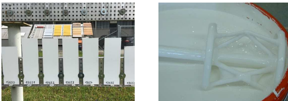
Abbildung 9: Freilandbewitterung der Funktionsmuster (links) und Ergebnis der Farbstabilitätsprüfung (rechts)
