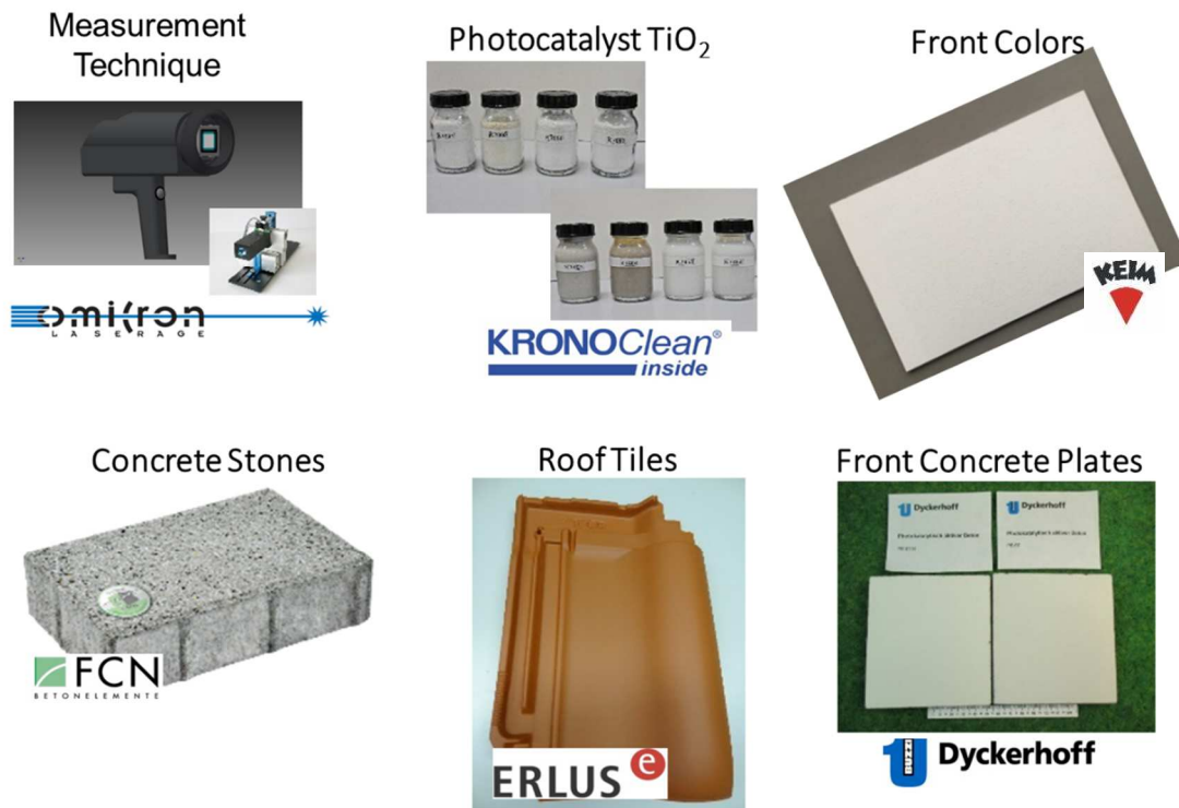
Abbildung 3: Überblick über die Ergebnisse von PureBau® - Es wurden Baumaterialien mit Depositionsraten für NO von 1 cm/s und mehr erreicht.
