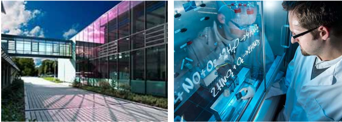
Abbildung 32: links: Fraunhofer-Institut für Schicht- und Oberflächentechnik Braunschweig IST; rechts: Messplatz zum NO_x -Abbau von photokatalytisch aktiven Materialien nach ISO
