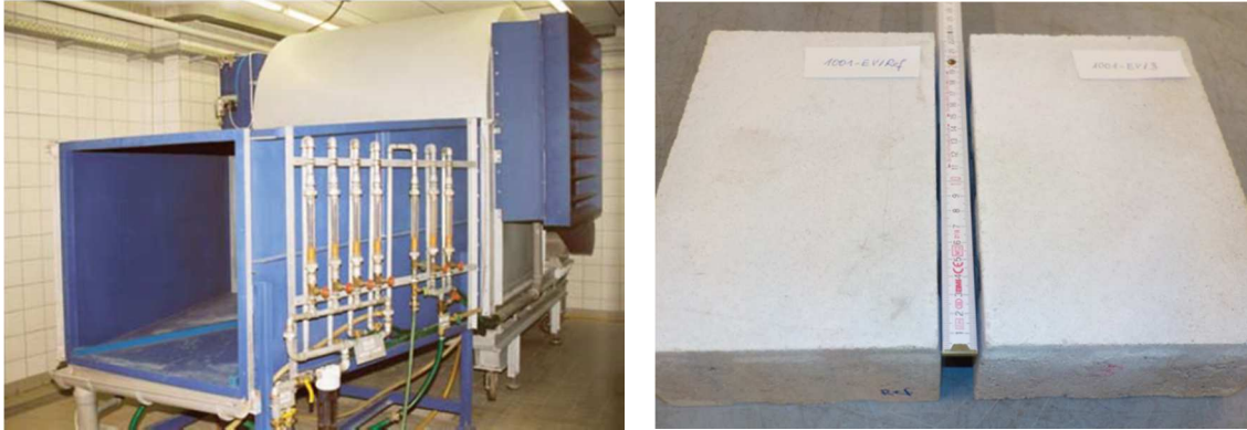
Abbildung 16: (links): Schlagregenprüfstand; (rechts): Ausblühungen nach einer Klimawechsellagerung – linker Stein nicht bewittert - rechter Stein bewittert.
