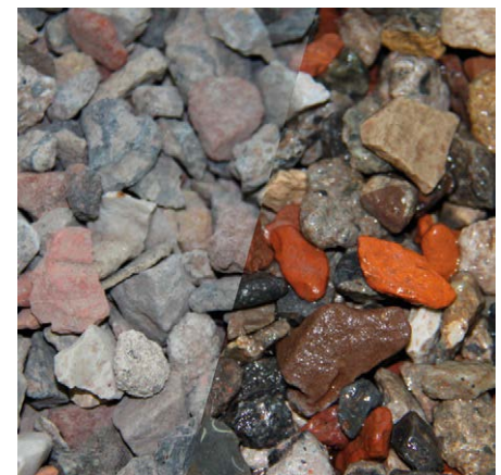
Bild 11: Rezyklierte Gesteinskörnung des Typs 2 in unterschiedlichen Feuchtezuständen Quelle: Technische Universität Kaiserslautern
