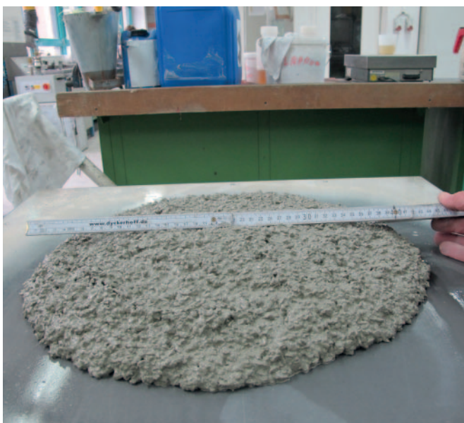
Fig. 15: Béton à ultra-haute résistance de granulométrie 0/5
