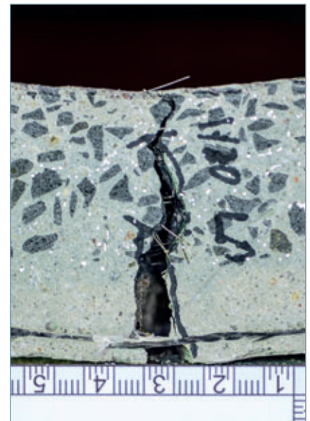
Abb. 8: Sandwichquerschnitt ( d = 4 \text{ cm} ) nach Prüfung
