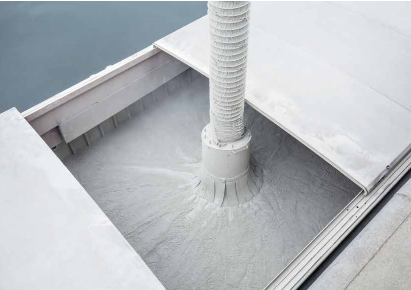
Per Verladebalg wird das Schiff mit Zement befüllt
