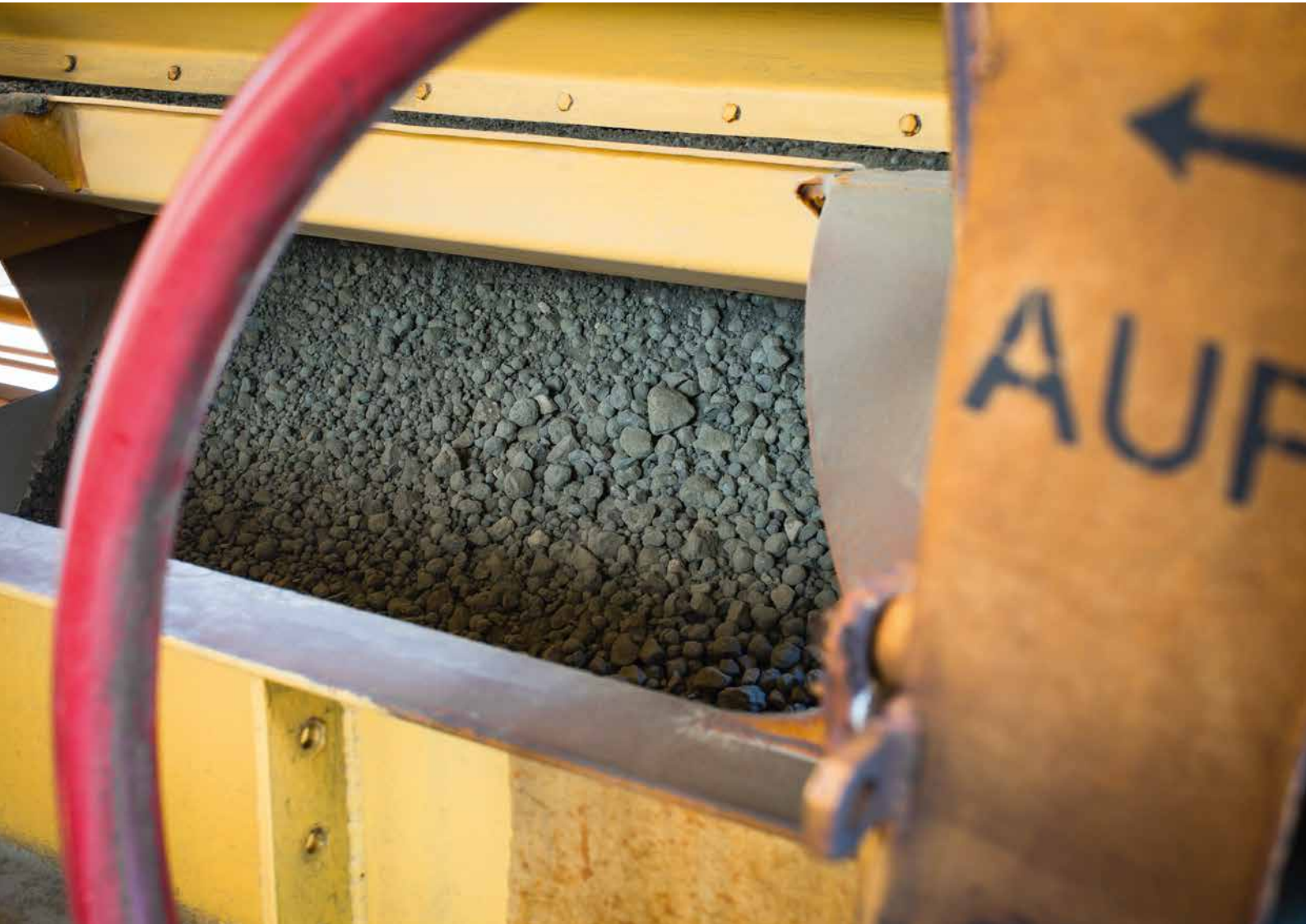
Über eine entstaubte Entladeeinrichtung wird der Zementklinker aus den Waggons entleert
