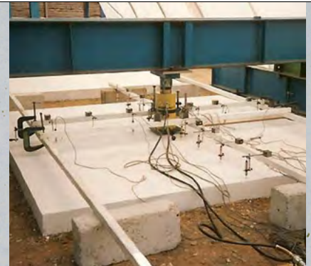
Abb. 4: Gebettete Platte mit Messeinrichtung
