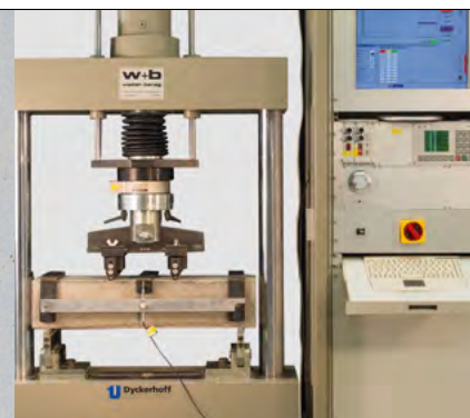
Abb. 2: Balkenprüfung im Wilhelm Dyckerhoff Institut
