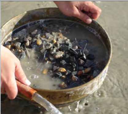
Abb. 26: Auswaschversuch mittels Kontrollsieb
