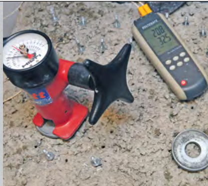
Abb. 17: Festigkeitsprüfung am jungen Spritzbeton
