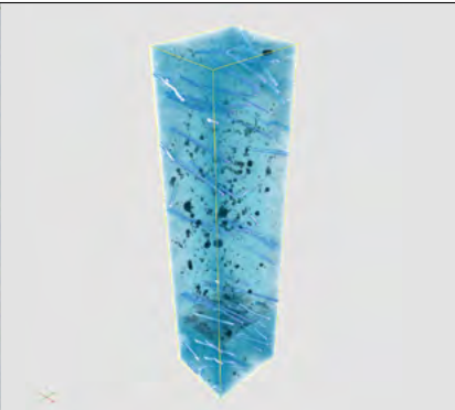
Abb. 19: Faserverteilung im Beton – Computertomographie; Quelle: Fraunhofer ITWM
