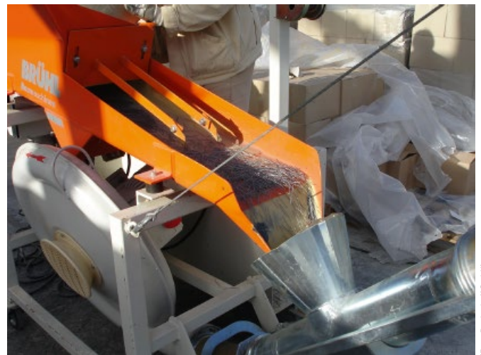
Bild 7 Stahlfaservereinzelnung Steel fibre separation
