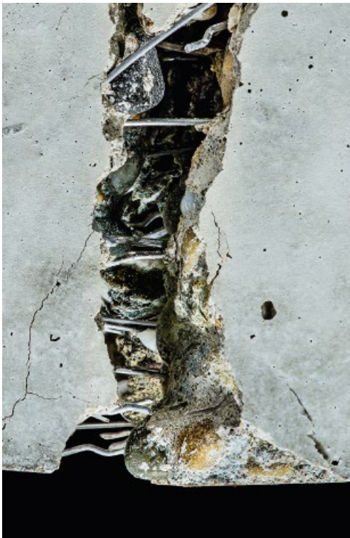
Bild 5 Rissüberbrückung durch Stahlfasern Crackbridging by steel fibre
