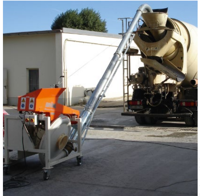
Bild 6 Stahlfaserdosierung mit Einblasgerät Steel fibre dosage by means a dosage advice
