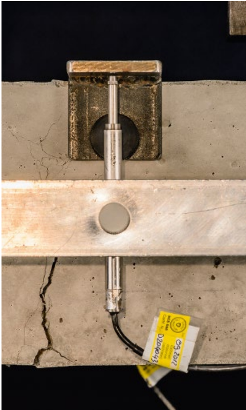
Bild 4 Erstriss nach Belastung First Crack after load
