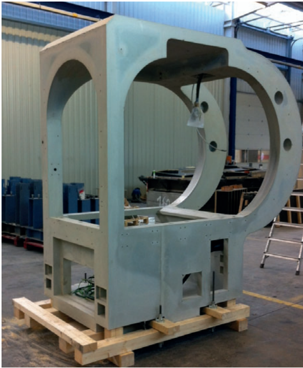
Figure 12 : À gauche : carcasse Subito Connect en une coulée. À droite : cellule pour robot de manutention Subito Connect de la société Fpt, Amtzell
