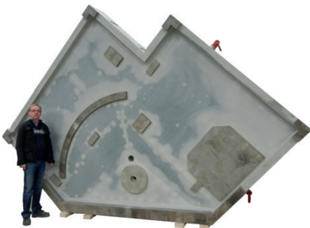
Figure 10 : Planéité et parallélisme < 0,03 mm avec plaques inox usinées
