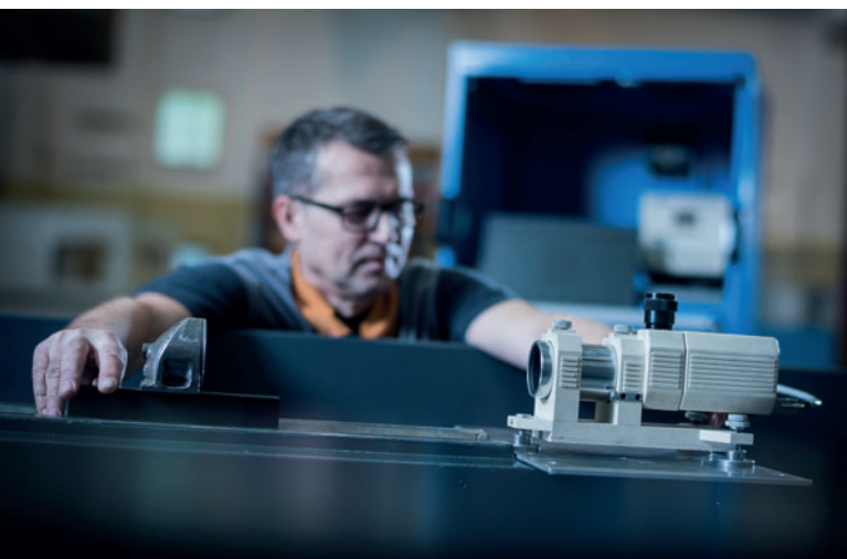
Figure 3 : Mesurage d'un banc de machine en BUHP
