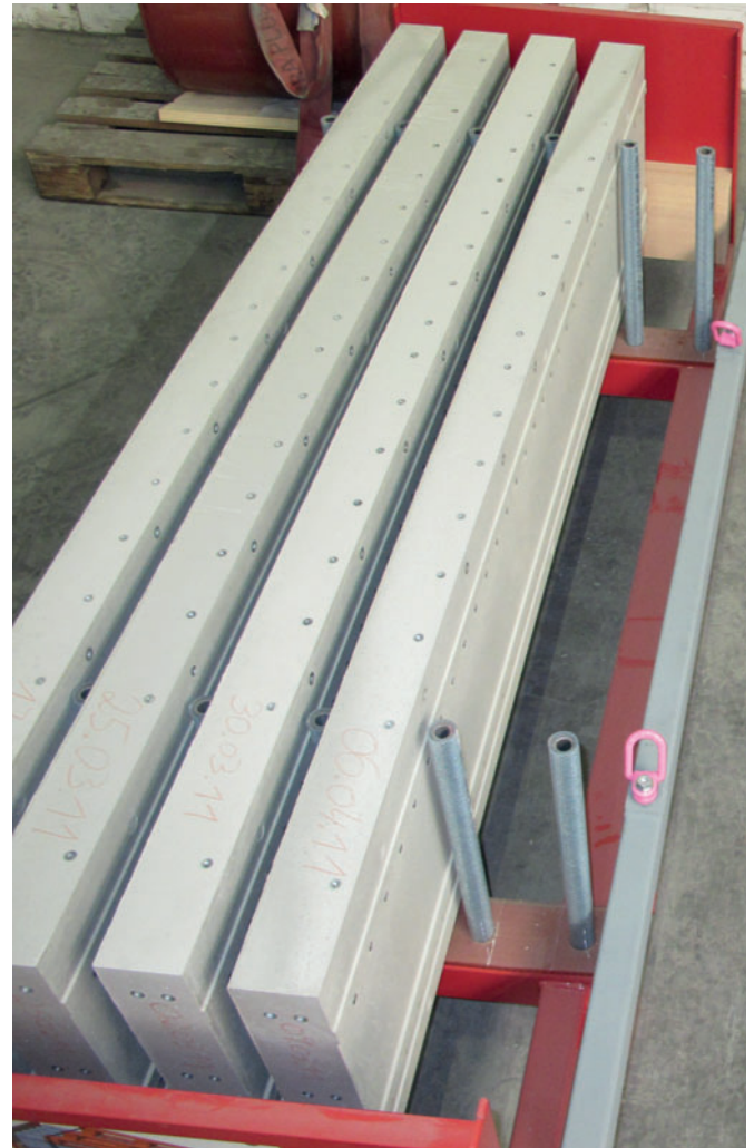
Figure 9 : Flèche latérale < 1/10 mm pour 2 500 mm de long, hors moule
