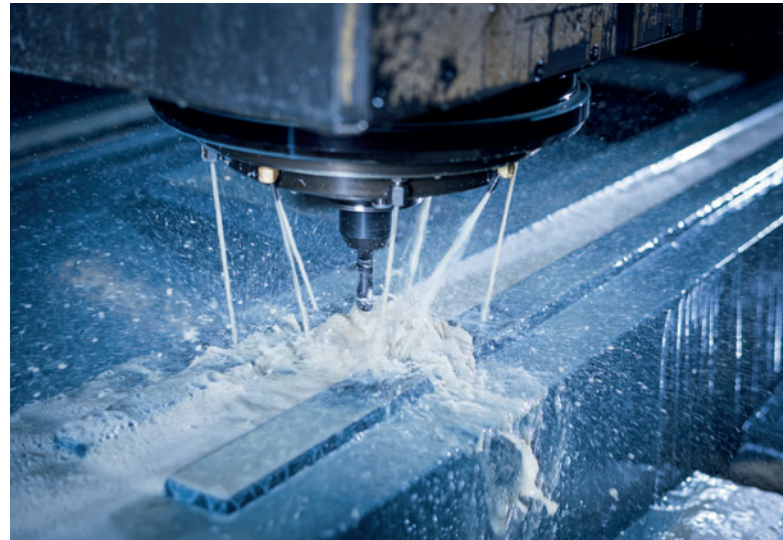
Figure 11 : Perçage et fraisage d'éléments incorporés en acier dans du béton Nanodur
