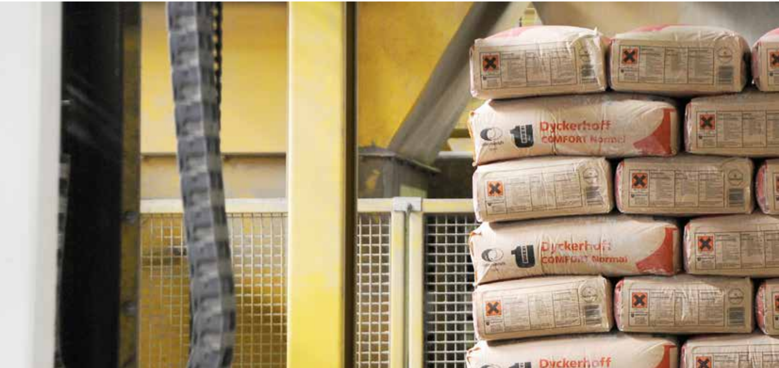
Mit einer vollautomatischen Palettieranlage werden die Zementsäcke auf Paletten gestapelt
