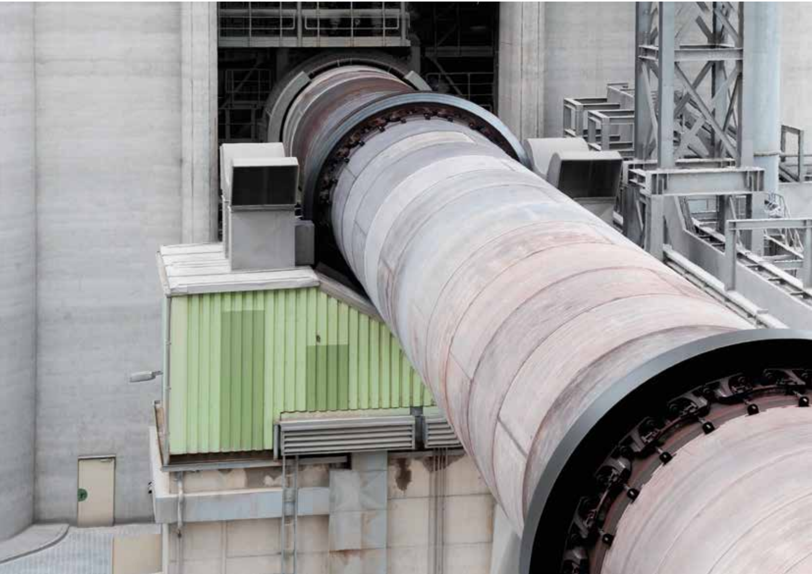
Klinkerbrennen an der Ofenanlage 8, einer der modernsten Anlagen Europas
